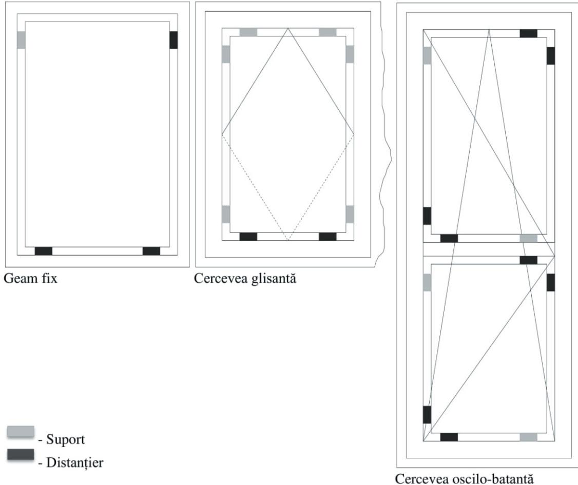
Exemple de montare a distanțierelor pentru modele de ferestre:
