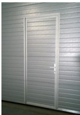
. Usile sectionale sunt configurate din combinatii de panouri de 500 mm si 610 mm. Usa pietonala se decupeaza in primele 4 panouri de jos. In cazul in care cele 4 panouri sunt de 500 mm atunci pietonala rezultata va avea inaltimea de 1800 mm (include pragul normal sau mic).
