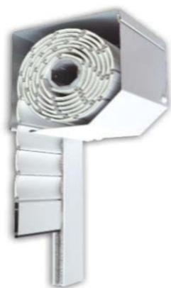
**Caseta acestui model de rulou este din aluminiu**, formată din partea fixă ce se montează pe exteriorul construcției pe tâmplărie sau perete și trapa de vizitare („trapa service”), element ce este ușor de detașat pentru lucrări de montaj și mentenanță. Caseta este închisă în părțile laterale cu capace din aluminiu cu profil special de conectare și aliniere cu ghidajele; pe aceste capace laterale se sprijină
